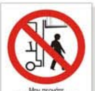
Μην περνάτε κάτω από αναρμωμένα φορτία οχημάτων διακίνησης
